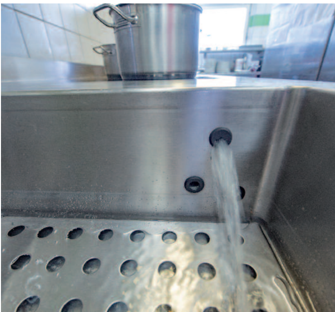
Das Bain-Marie verfügt über eine automatische Wasserstandskontrolle und -nachfüllung.
